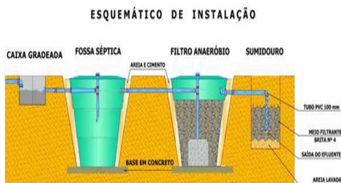
Figura 2. Fossa séptica com filtro anaeróbio e sumidouro
