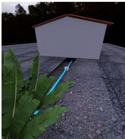
Figura 8. Caixa de passagem e tubulação
