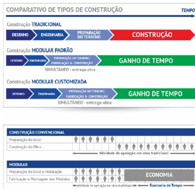
Figura 11 - Comparativa de tipos de construção tradicional e modular e economia de tempo
