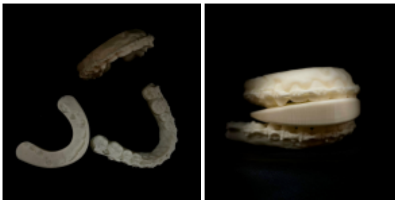
Figura 1 e 2: Réplica anatômica para fins de procedimentos odontológicos, guia construída por Prototipagem 3D.
