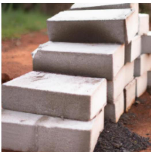
**Figura 6:** Blocos de concreto de entulho.
